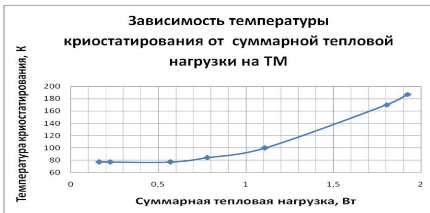
Рис. 1. Зависимость температуры криостатирования МКС от суммарной тепловой нагрузки на ТМ
