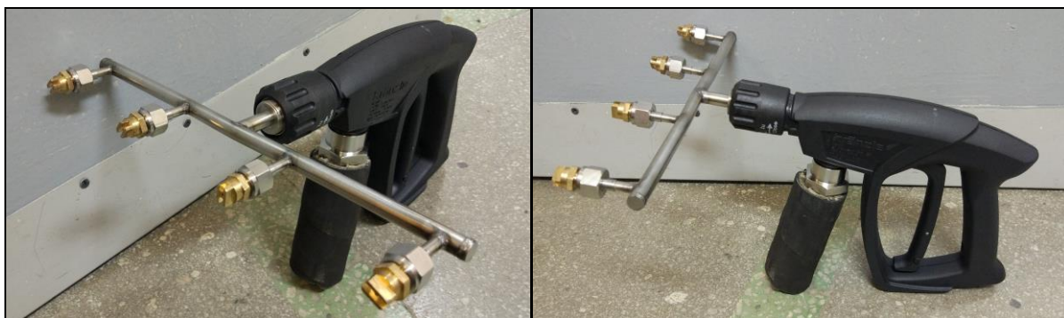
Рис. 2. Внешний вид пистолетного устройства и коллектора с форсункам и для распыления криоагента
