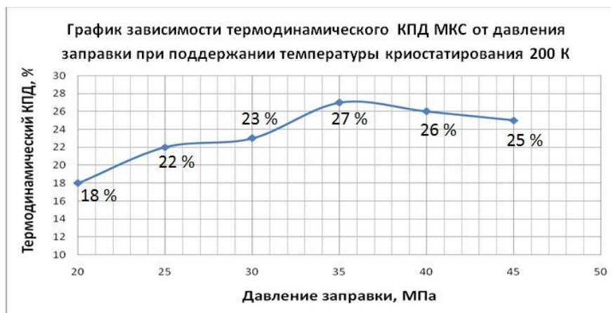
Рис. 4. График зависимости термодинамического КПД образца МКС от давления криоагента при поддержании температуры криостатирования 200 К
