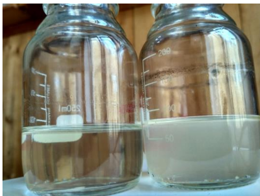
Рис. 1. Опыт №1 «Очистка речной воды от дизельного топлива». Слева – контрольный образец, справа – образец с препаратом
