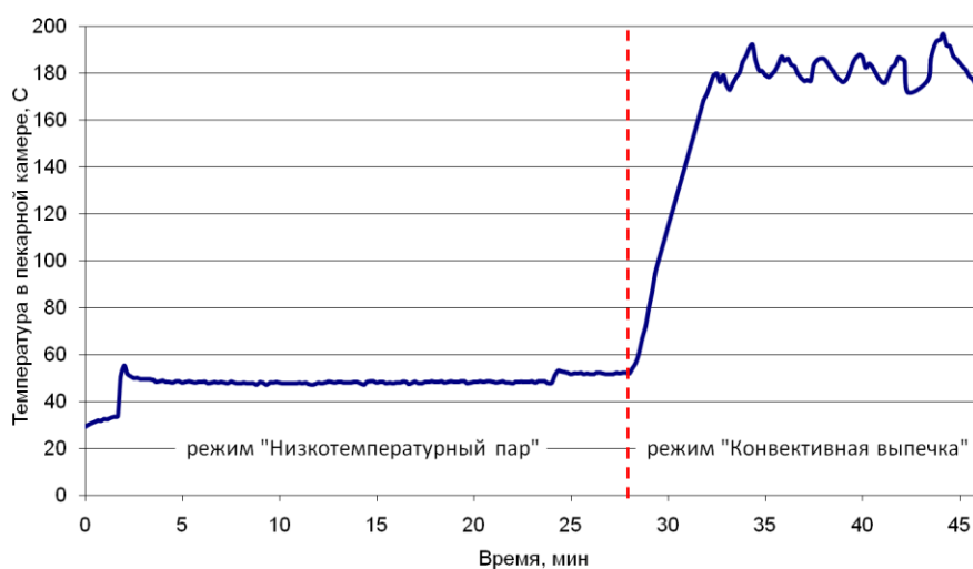
Рисунок. Изменение температуры в пекарной камере пароконвектомата
