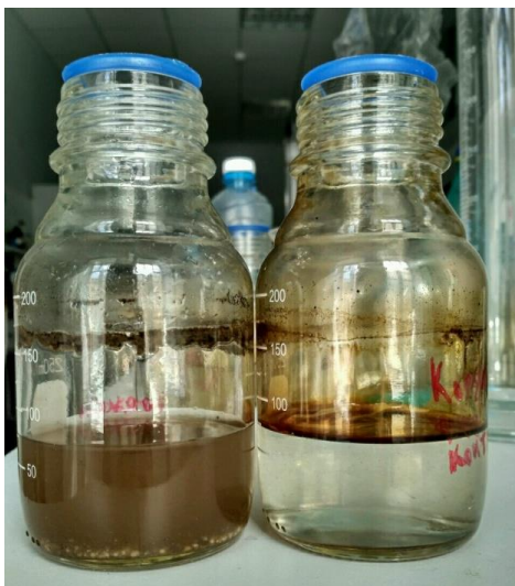
Рис. 2. Опыт №2 «Очистка речной воды от сырой нефти». Слева – опыт, справа – образец с препаратом
